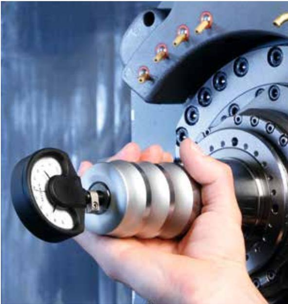
Zum Überprüfen der Einzugskräfte von Spannsystemen in Maschinenspindeln.
